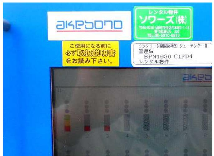
⑤1chが充填され、締固めの振動を検知しました。
