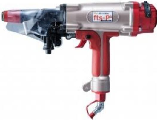
空気圧により専用ピンを吹付けコンクリートに打込み、その貫入深さによって吹付けコンクリートの初期強度を推定する試験機です。
