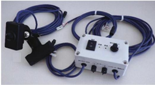
高所作業車のバスケットが上昇する際に、上部構造物との衝突を未然に防ぐための補助装置です。
