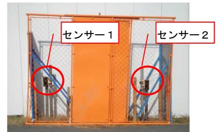
※センサーは道路幅最長20mに渡り赤外線監視をしています、センサー1 → センサー2 の順番で通過した車両のみを検知して回転灯を回します。
